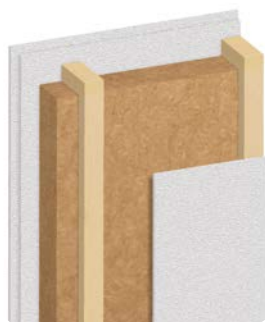
Tabique ligero de separación con montantes de madera, GUTEX Thermofibre GUTEX Thermoflex / GUTEX Thermosafe-homogen
