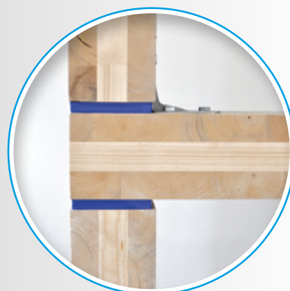
Configuración medida en el ensayo: con escuadra de unión y tirafondos
